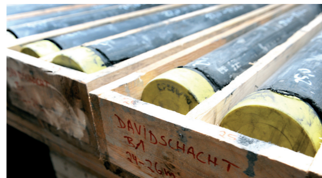
Bohrkerne aus der Spülhalde Davidschacht, Freiberg (HIF)
